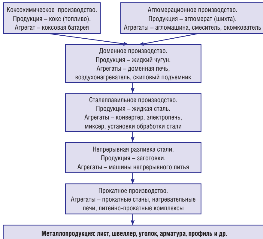
Рис. 1. Схема непрерывного металлургического производства
